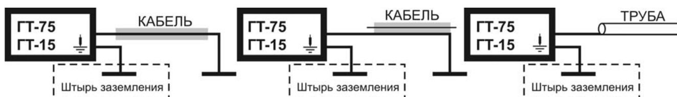
Рисунок 2.3.1 – Варианты подключения к коммуникациям:
