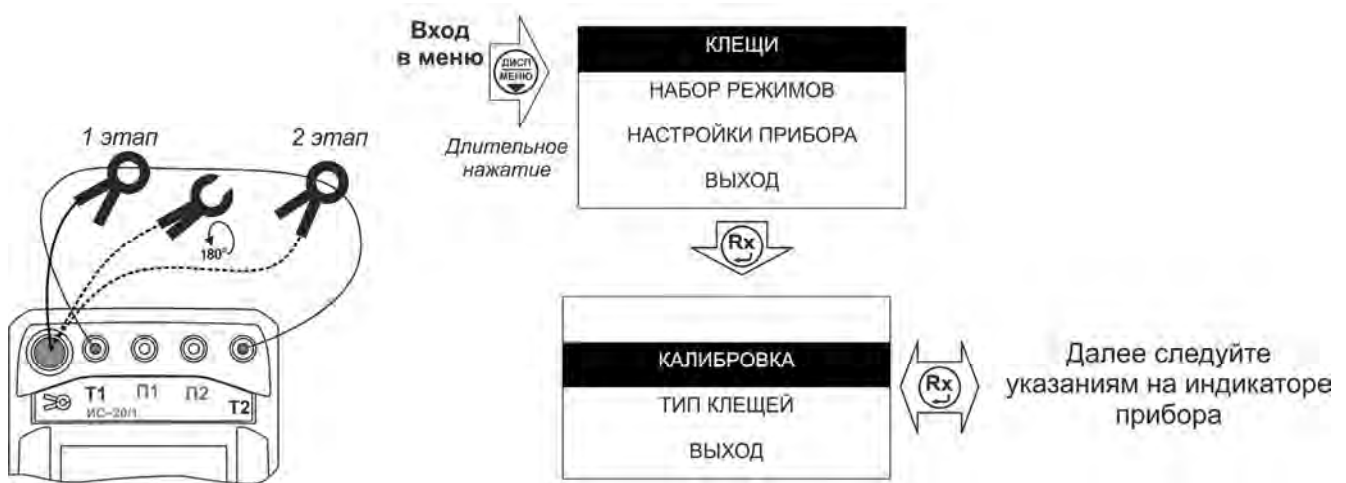
Рисунок 2.14 – Калибровка токоизмерительных клещей
