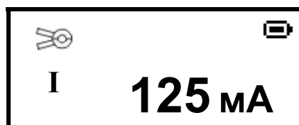
Рисунок 2.3.7 - Вид индикатора при измерении переменного тока с применением клещей
